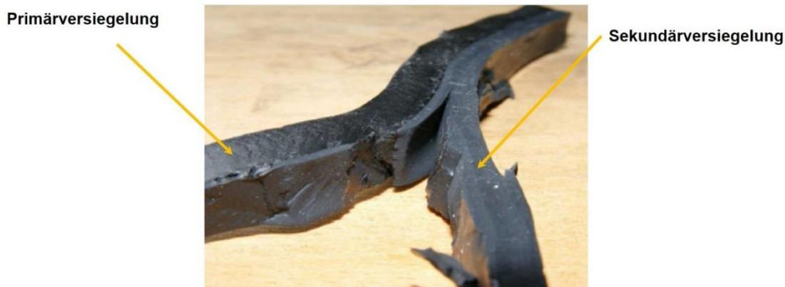
Abbildung 96: Keine Ablösung zwischen Primär- und Sekundärversiegelung nachweisbar (Bericht Chemische Fabrik Kömmerling GmbH 2014)
