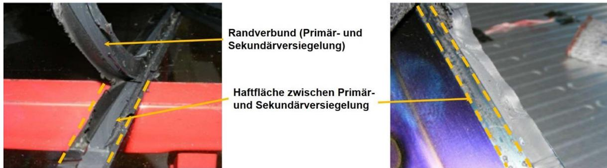
Abbildung 95: Keine Verlust der mechanischen Belastbarkeit nach Exposition und Stresstest nachweisbar (Bericht Chemische Fabrik Kömmerling GmbH 2014)
