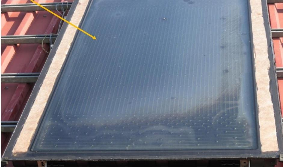
Abbildung 92: Großflächige Ausgasung an der Scheibeninnenseite
