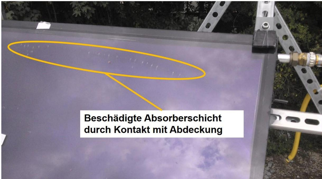
Abbildung 77: Detailaufnahme der beschädigten hochselektiven Beschichtung am Funktionsmuster TPS-1
