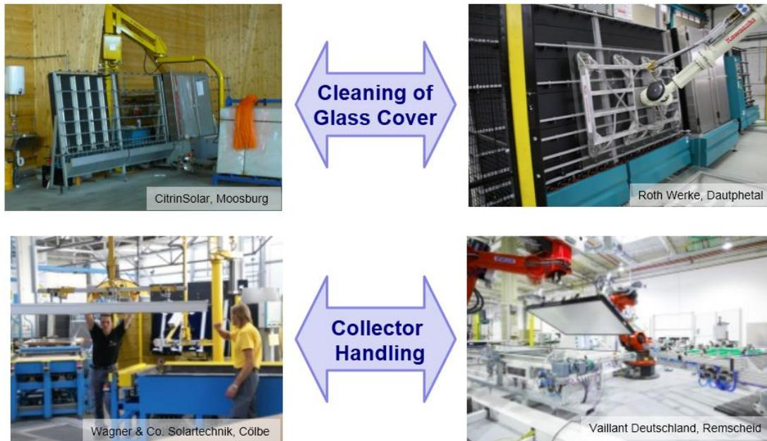
Abbildung 10: Verschiedene Ansätze für einen identischen Fertigungsschritt (Müller und Zörner 2010)
